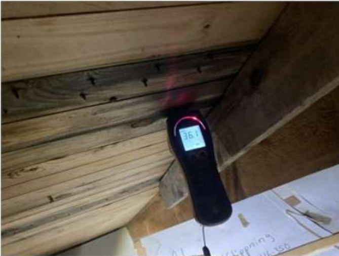
Mätning av fuktkvot på vind.
